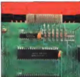
Il 6845, chip video programmabile, parallelamente, viene pilotato dalla stampante.
